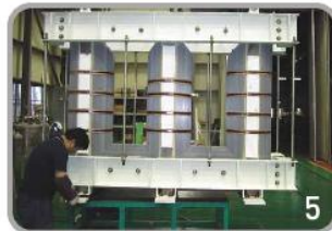
5 Stack cores (코아 조립)
